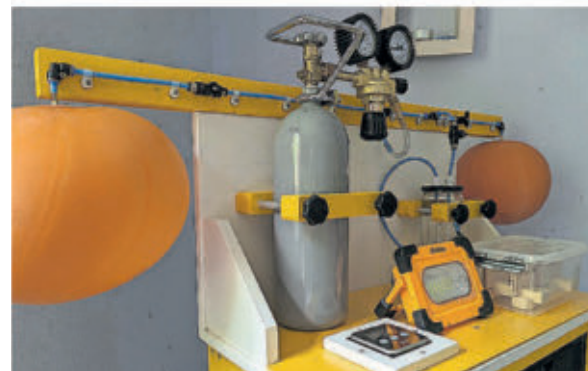
Mit dieser selbst gebauten Maschine begast Gilbert Bast seine Königinnen mit CO 2 . Bevor er es ihnen zuführt, wird es in den orangenen Bällen aufgewärmt.
